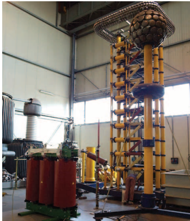
Lightning impulse test at CESI (MI)
