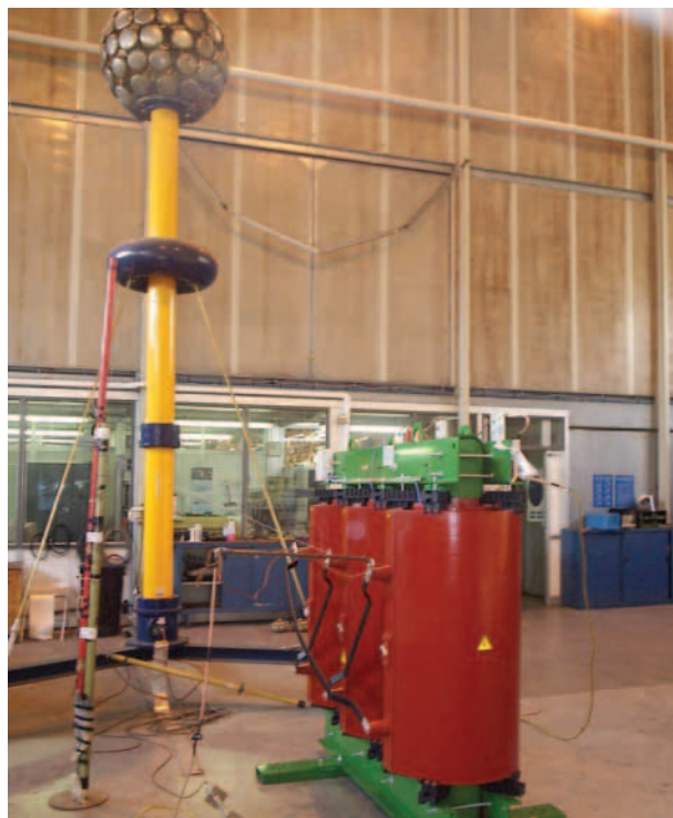
Lightning impulse test at CESI (MI)
